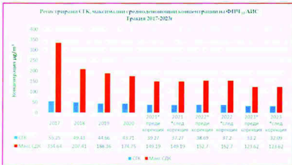
Фигура №IV.1.а.6 Регистрирани СГК и максимална средноденонощна концентрации в АИС „Тракия“ за периода 2017-2023г.
