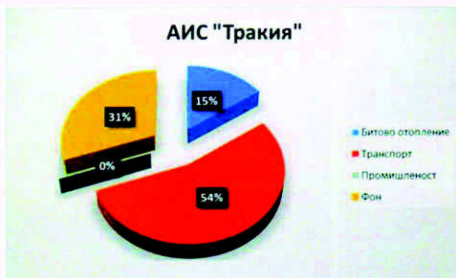
Фигура V.3.1.E.2 Принос на различните групи/сектори в средногодишната концентрация на ФПЧ10 в АИС „Тракия“
