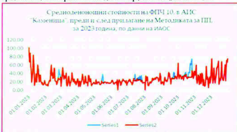
Фигура № IV.1.а.27 Динамика на регистрираните в АИС „Каменица“ концентрации на СДК на \text{ФПЧ}_{10} за 2023 г., преди и след корекция на пустинен прах, Източник: ИАОС, 2023г.
