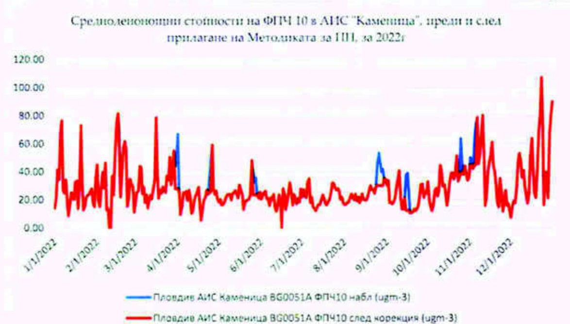
Фигура № IV.1.а.25 Динамика на регистрираните в АИС „Каменица“ концентрации на СДК на ФПЧ10 за 2022г, преди и след корекция на пуховинен прах
