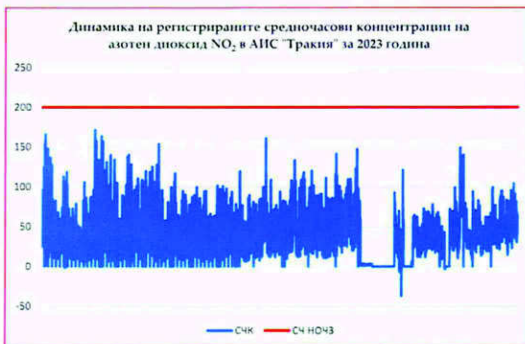
Фигура №IV.1.d.4. Динамика на регистрираните средночасовите стойности на азотен диоксид в сравнение с годишната норма, в АИС "Тракия", за 2023 г.
