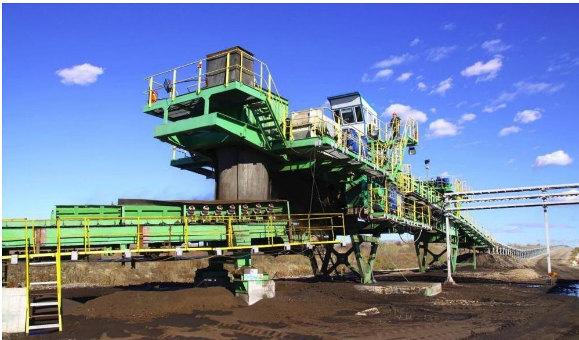
Гумено-транспортна лента (ГТЛ) и задвижваща станция
