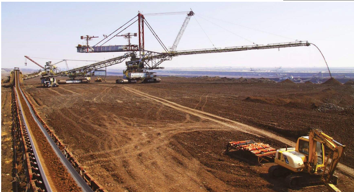
Лентов насипообразувател за насипване на откритката
