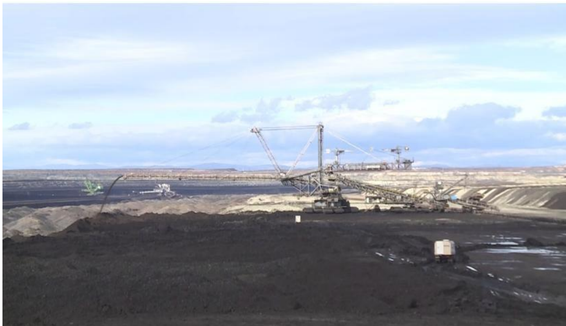
Лентов насипообразувател за насипване на пепелина и шлам
