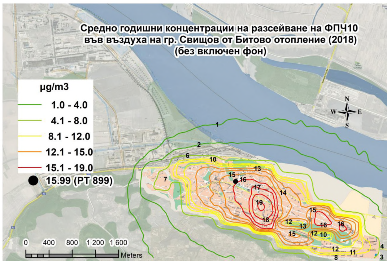
Фиг. 5.2.4. Резултати от моделиране на СГК на ФПЧ10 от Битово отопление на гр. Свищов (2018)
